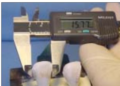
Illustration 1 : Compas numérique fournissant des mesures à 0,01 mm près.
